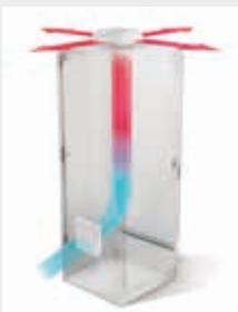
例えば、キャビネットの側面が障害物や壁、他のキャビネットの側面で覆われている場合、熱風はキャビネットの屋根からも排出されます。完璧な構成では、排気フィルターはキャビネットの底に配置されます。ルーフユニットが発生させる低圧 ルーフユニットによって発生する低い圧力が、排気フィルターを通して外部の冷たい空気を取り込み、内部の空気の流れと熱の放散を促進します。
